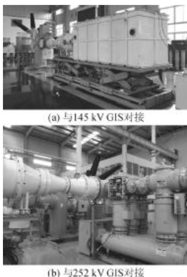
图5 对接冲击试验现场
